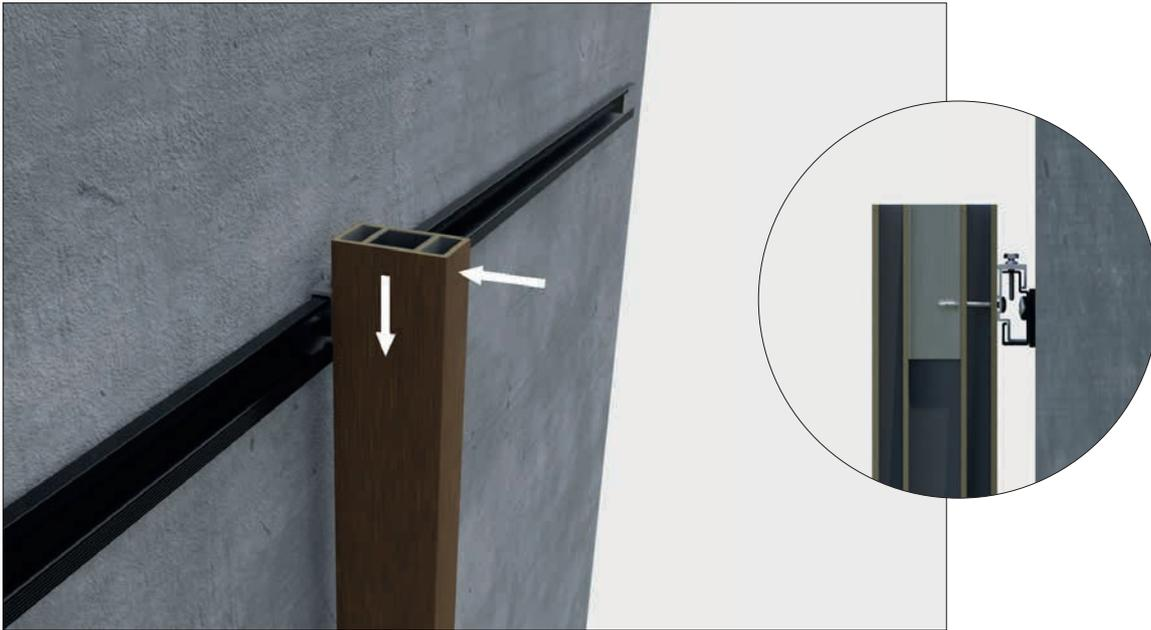
**SCHRITT 4** Installieren Sie den Brise Soleil mit dem NV3-Clip an der Schiene.
