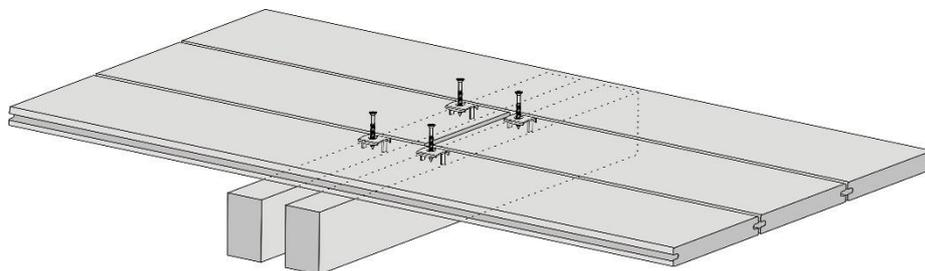
Weiterhin ist die Unterkonstruktion so zu planen, dass die später zu verlegenden Dielen ein **Gefälle von 2%** (= 2 cm pro lfdm) in Dielenrichtung erreichen, um einen entsprechenden Wasserablauf zu gewährleisten.
