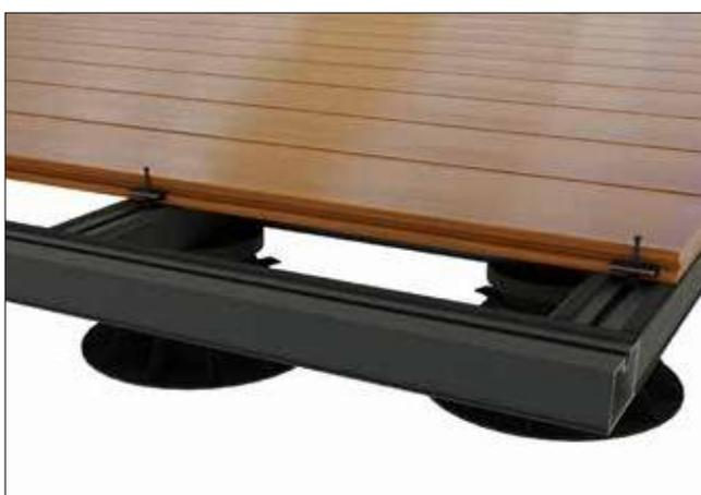
4.5 - Sichern Sie das letzte Brett mit dem Start / End-Clip. Durch das längliche Loch im Clip können Sie es entsprechend der Höhe der Nut im Deckbrett einstellen. Befestigen Sie die Blende mit 4x35 mm Schrauben am Umfang des Rahmens.
