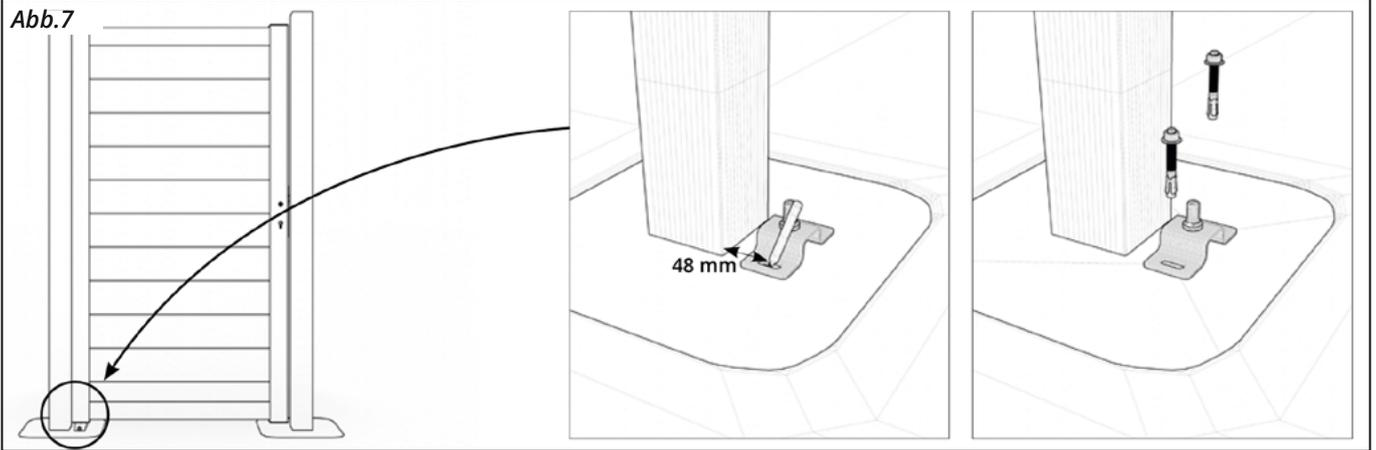
7. Beim Beschlagsatz für die Tore ist ein Dorn zur Bodenmontage enthalten (für Beton, Pflaster oder Asphalt Montage). Hierfür wird der Dorn mit 2 Schrauben auf dem Boden fest gebült und geschraubt (vom Pfosten bis Dornmitte 48 mm).
