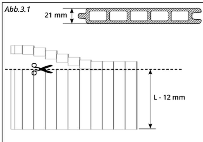
3. Die Füllung muss 12 mm kürzer als das Tor zugeschnitten werden. Mit etwas Luft zwischen Rahmen und Füllung wird gewährleistet, dass sich die Füllung im Torrahmen ausdehnen kann, ohne Spannung zu erzeugen.
