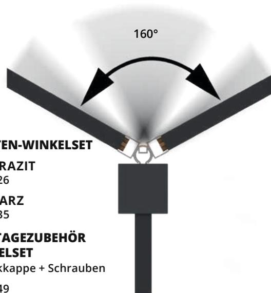
Mit dem variablen Pfostenwinkelset für den BOSTON-Zaun montieren Sie den Zaunverlauf in jedem beliebigen Winkel.
