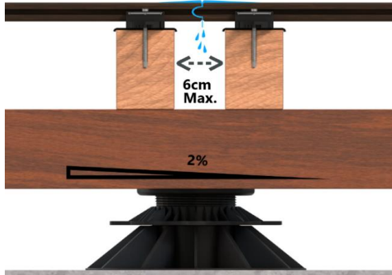
Figuur 4: Dubbele onderconstructie met dubbele onderbalk bij de uiteindes van de terrasplanken, voor houten of bamboe terrassen.
