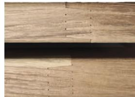
Durch liegende Keilzinkung und technische Trocknung formstabiler.
